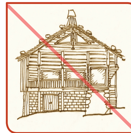
Baies aux formes contemporaines inadaptes au caractère ancien du chalet
